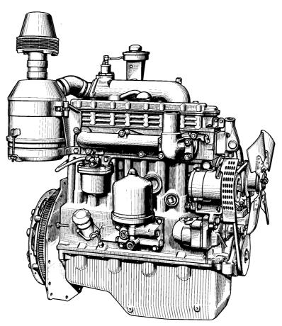
Fig. 4 – D-242 Diesel Engine (Right View).
